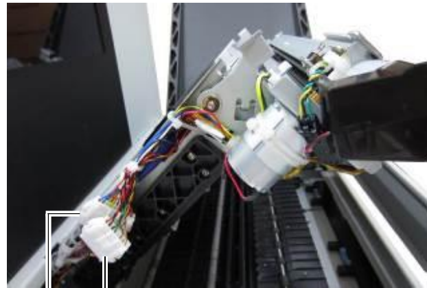
Abbildung 6 Kabelverbinder auf der linken Seite der Druckeinheit.
